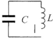
$\begin{cases} q(t) = q_{\max} \sin(\omega t + \varphi_0) \\ I(t) = q'_t = \omega q_{\max} \cos(\omega t + \varphi_0) = I_{\max} \cos(\omega t + \varphi_0) \end{cases}$ <p>Формула Томсона: <math>T = 2\pi\sqrt{LC}</math>, откуда <math>\omega = \frac{2\pi}{T} = \frac{1}{\sqrt{LC}}</math>.</p> <p>Связь амплитуды заряда конденсатора с амплитудой силы тока при свободных электромагнитных колебаниях в идеальном колебательном контуре: <math>q_{\max} = \frac{I_{\max}}{\omega}</math></p> |
